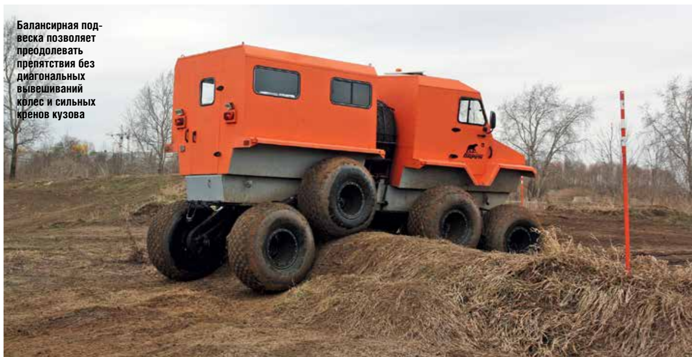
Между «ушками» на раме и балансирах можно установить стяжку для замены колеса без домкрата или даже езды вовсе без колеса
